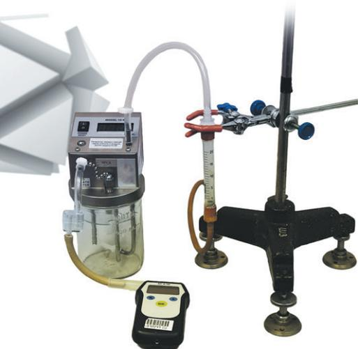
**Генераторы газовых смесей паров этанола в воздухе GUTCH 1 разряда** для
