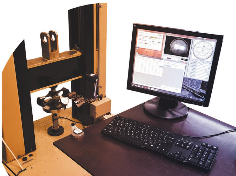
**Автоматизированное рабочее место поверки моментного инструмента.**
