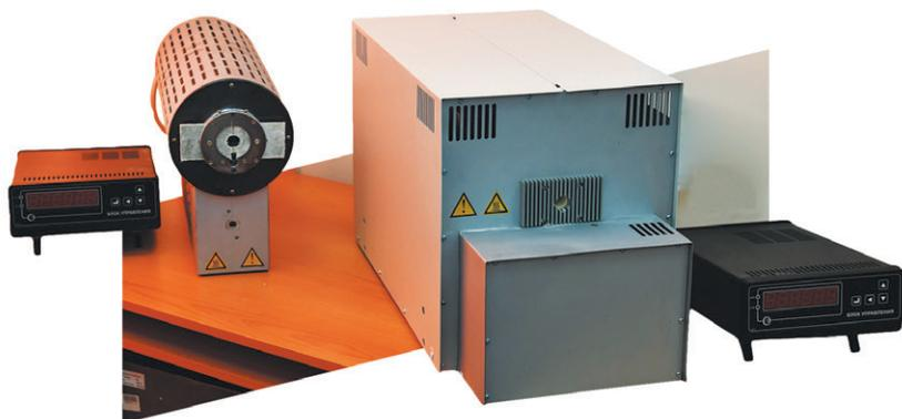
**Аппаратура и ампулы** для реализации реперных точек температуры 0-го разряда по МТШ-90 для поверки эталонных термопреобразователей и термометров сопротивления в диапазоне от 0,01 до 1084,62 °С.
